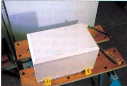
Die Spannung steigt: Nun sitzen schon die beiden Deckel, als nächstes kommt die Schallwand dran.
