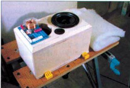
Letzte Dinge regeln: Frequenzweiche gut befestigen, Kabel anlöten, Chassis festschrauben – und ab in den Hörraum!
