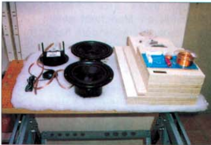
Puzzle: die Box in Einzelteilen. Fürs Gehäuse nahmen wir statt MDF oder Spanplatte das schönere Birkenesperrholz.
