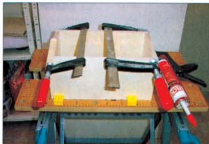
Der erste Schritt: Die Seitenwände werden zusammengeklebt. Achtung: auf rechte Winkel achten!
