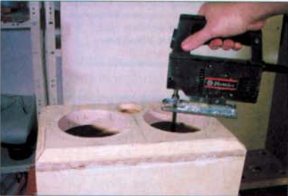
Ausrüstung ist alles: Die Öffnungen für die Chassis und das Anschlussterminal schneidet man mit einer Stichsäge.
