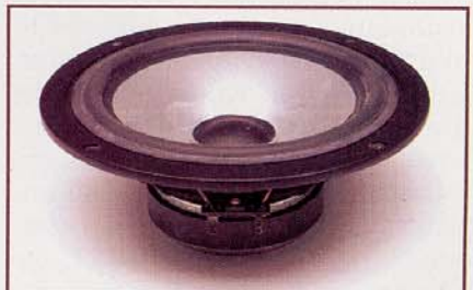
Der Tieftöner aus der Fontana, es handelt sich um den AL 170 von Visaton, zeichnet sich durch zahlreiche technische Feinheiten aus: Er besitzt eine hinterlüftete Zentrierspinne, eine großvolumiger Polkernbohrung, und eine Kapton-Schwingspule mit einer Wickelhöhe von 18 mm.
