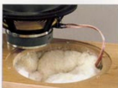
Das Gehäuse ist relativ stark bedämpft
