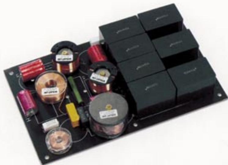
Auf der Frequenzweiche dominieren die großen MKP-Kondensatoren
