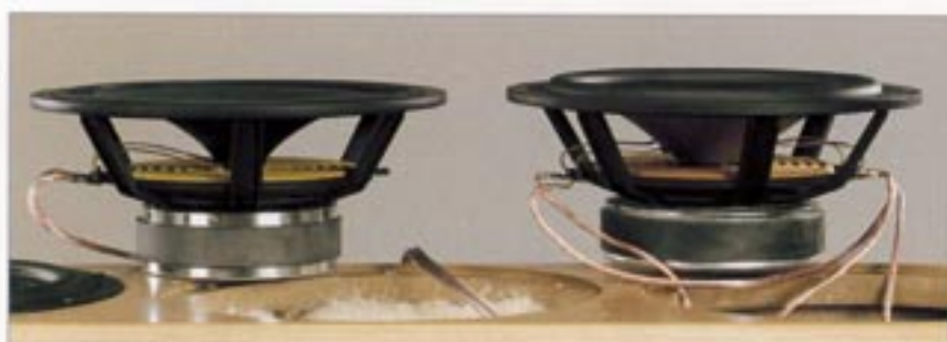
Links der B 200, rechts einer der Doppelschwingspulen-Tieftöner. Die Verkabelung ist vom Typ „no nonsense“, aber mit ausreichendem Querschnitt
