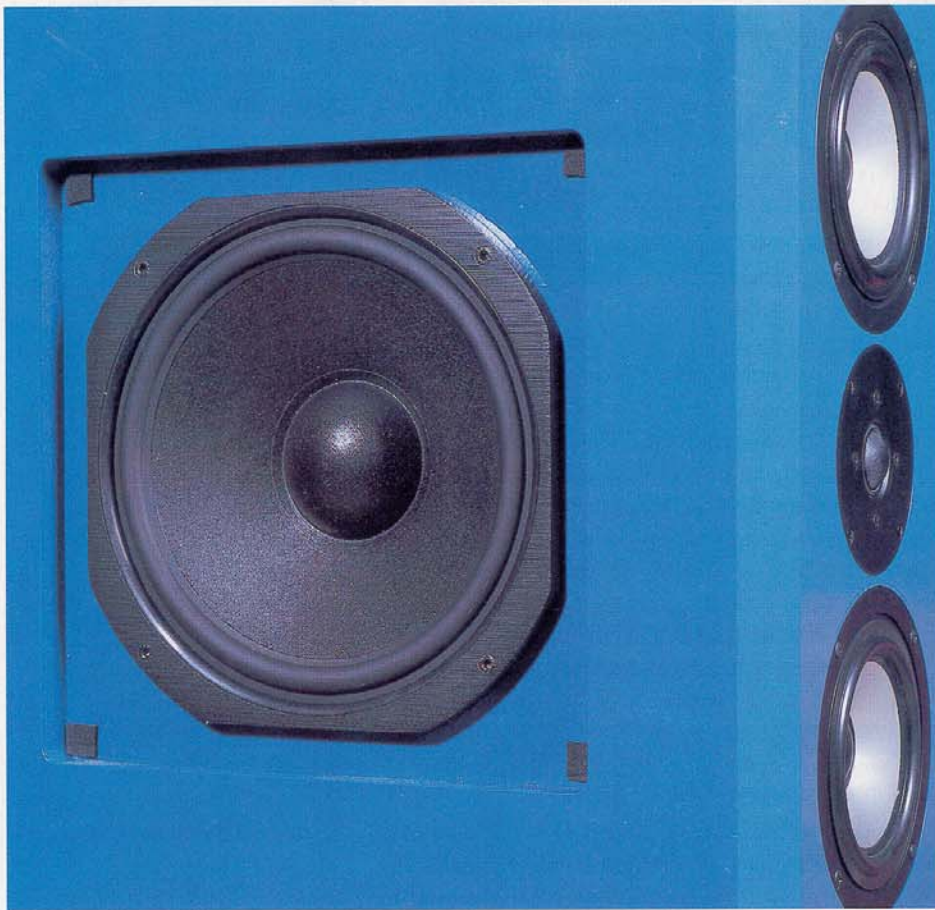
Der Tieftöner ist mit seinem sehr kräftigen Gußkorb fest in der Seitenwand verankert
