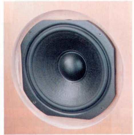
Raffiniert wurde der TIW 250 eingebaut: Die Einfräsung wurde wesentlich vergrößert, damit das runde Gitter als Abdeckung passte. Gleichzeitig wird damit der Basslautsprecher bündig in der Schallwand versenkt. Lange Inbusschrauben sorgen für festen Halt des Chassis.
