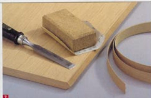
7 Klebfurnierstreifen auf Seiten- und Oberkanten aufbügeln (Einstellung „Leinen“); Überstände mit dem Schleifklotz und feinem Sandpapier entfernen
