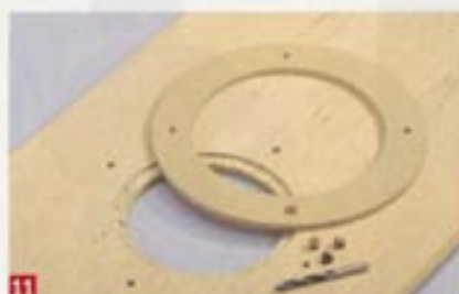
11 Einsteckdübelpositionen mit Markierungsstiften auf die Front übertragen; 10-mm-Löcher bohren
