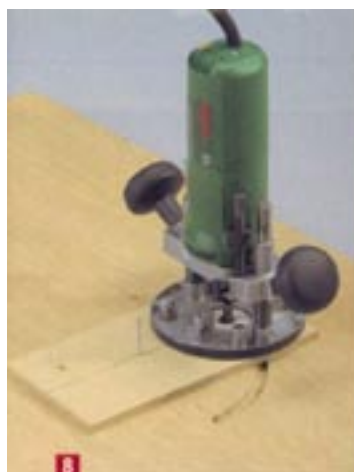
8 Nut für das Chassis mit improvisiertem Fräszirkel in zwei Gängen fräsen
