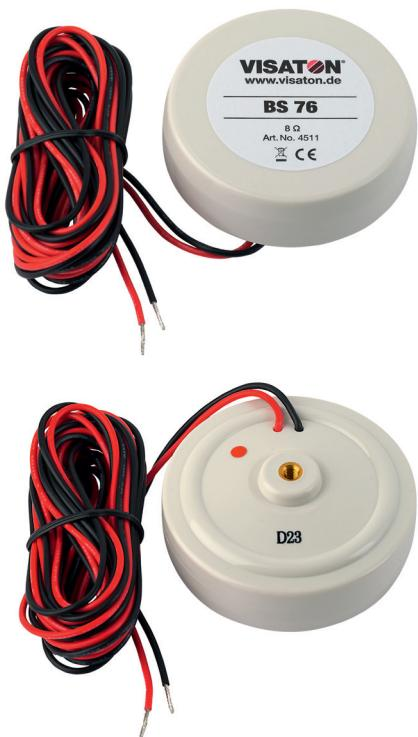
**Körperschallwandler** für die Mittel- und Hochtonwiedergabe. Die Montage (mit Schraube M5) erfolgt auf einer schwingfähigen Fläche, die dadurch direkt zum Schwingen angeregt wird. Ein geschlossenes Gehäuse ist nicht notwendig.
