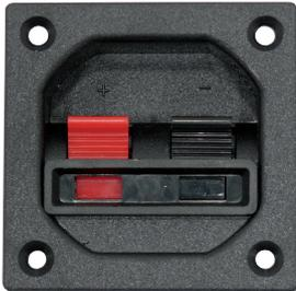
**Lautsprecher-Anschlussklemme** mit versenkt angebrachter Klemmleiste und Schaumstoffdichtung zum luftdichten Einbau. Für Kabelquerschnitte bis 10 mm<sup>2</sup>, 2-polig, je 1 roter und 1 schwarzer Druckhebel. Runde Einbauöffnung. Inkl. Schrauben zur Befestigung.
