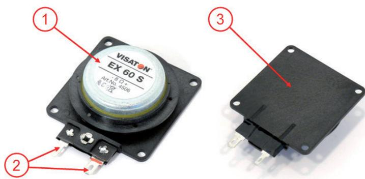
Durch Anlegen eines Signals (z.B. Musik- oder Sprachsignal) an das Anschlussterminal vibriert die schwingfähige Masse im Takt der Musik. Die Schwingung überträgt sich auf die Montageplatte und wird von dieser an die anzuregende Platte weitergegeben. Die so angeregte Platte strahlt dann das Musik- oder Sprachsignal ab. Die Funktion eines Exciters ist also der eines Standardlautsprechers sehr ähnlich.
