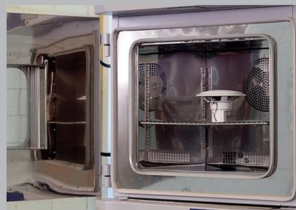
Klimakammer mit dem sehr großen Temperaturbereich von  $-70\text{ }^{\circ}\text{C}$  bis  $+180\text{ }^{\circ}\text{C}$
