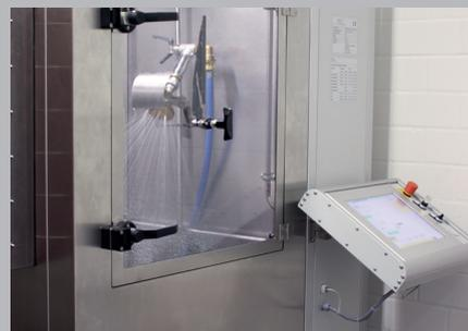
IP-Messkammer für normgerechte Prüfungen der Wasserfestigkeit (IP-Klassifikation)
